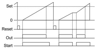
Start girişine sinyal uygulanması ile çıkış aktif olur. Sayılan değer set'e ulaştığında çıkış pasif olur. Start sinyali kesildiğinde çıkış kapatılır. Start sinyali tekrar uygulandığında çıkış enerjilenir ve sayma işlemi kaldığı yerden devam eder.
