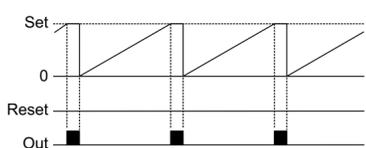
Reset işlemi, otomatik yapılır. Sayma, set değerine kadar devam eder ve Batch Counter çıkışı aktif iken sayma durdurulur. Sayılan değer Batch Counter çıkışı pasif olduğunda sıfırlanır ve sayma devam eder. Batch Counter çıkışı pulse li çalışır.
