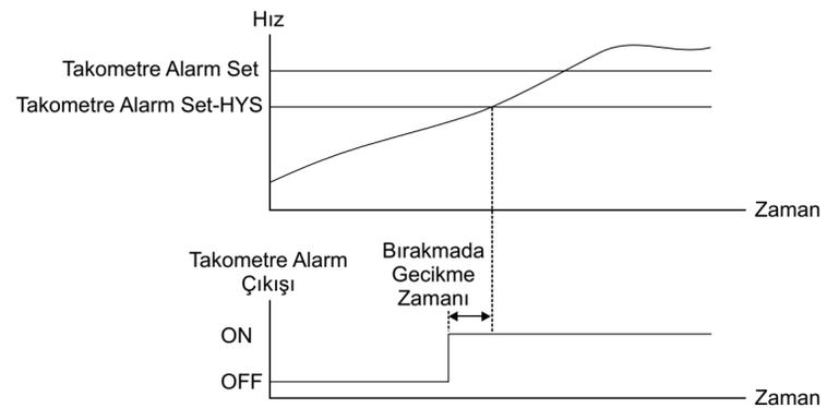
**P-19 Takometre Alarm Çıkışı için cihaza enerji verildikten sonraki kontrol gecikmesi (0.0 ... 999.9 saniye)**
