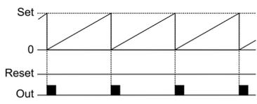
Reset işlemi, otomatik yapılır. Sayma, set değerine kadar devam eder, set değerine ulaştığında sıfırlanır. Batch Counter çıkışı pulse li çalışır.
