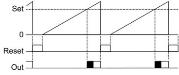
Reset işlemi, manual yapılır. Sayma, reset işlemi gerçekleşinceye kadar devam eder. Batch Counter çıkışı pulse veya sürekli çıkış verecek şekilde ayarlanabilir.
