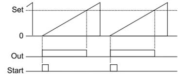
Start girişine sinyal uygulanması ile çıkış aktif olur ve sayılan değer sıfırlanır. Sayılan değer set'e ulaştığında çıkış pasif olur. Start sinyali kesildiğinde işlem set değerine ulaşana kadar devam eder. Sayma değeri set'e ulaştığında çıkış kapatılır.
