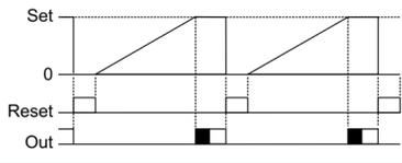
Reset işlemi, manual yapılır. Sayma, set değerinde durdurulur. Batch Counter çıkışı pulse veya sürekli çıkış verecek şekilde ayarlanabilir.
