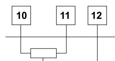
Potansiyometre bağlantısını şekilde gösterildiği gibi yapınız. Potansiyometre orta uç bağlantısına dikkat ediniz.
